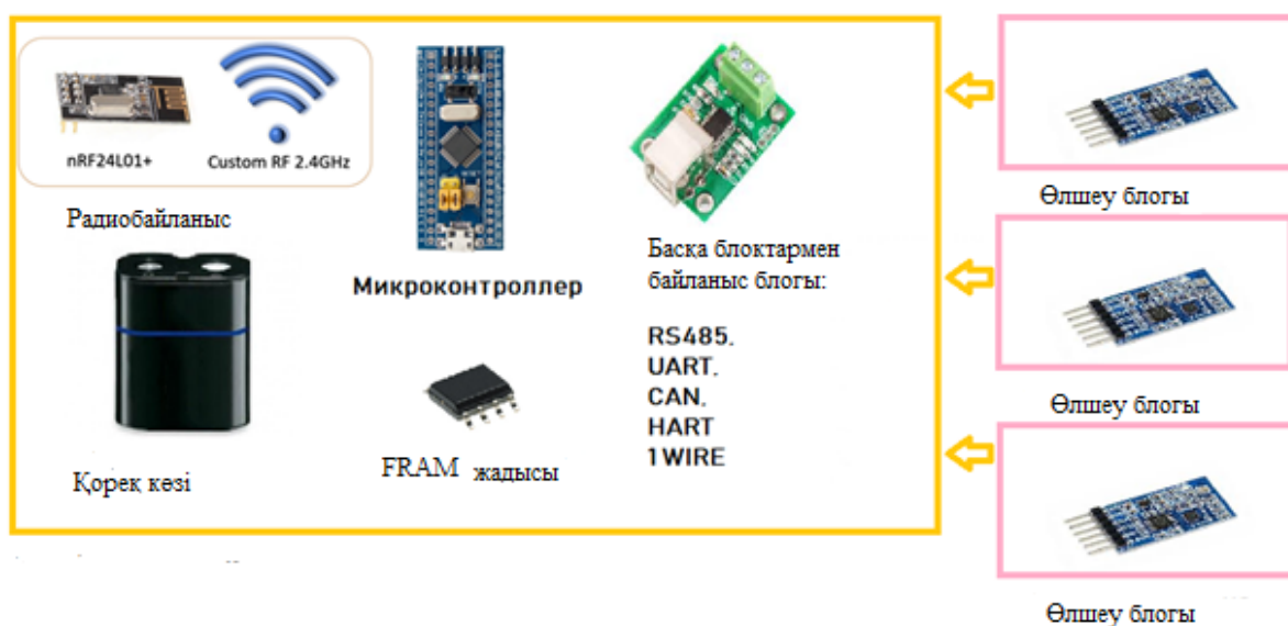
2.2 сурет - STM32 микроконтроллеріне өлшеу блоктарының қосылуы
